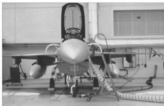
nativas adequadas, estes equipamentos são usados com muita frequência no interior de hangares durante horas a fio provocando problemas graves de exposição ao ruído e inalação de gases tóxicos, muito particularmente durante o Inverno em que por imperativo das condições meteorológicas é necessário fechar as portas dos hangares.
